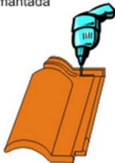
Furo na parte posterior da telha para fazer a fixação com parafuso ou arame
