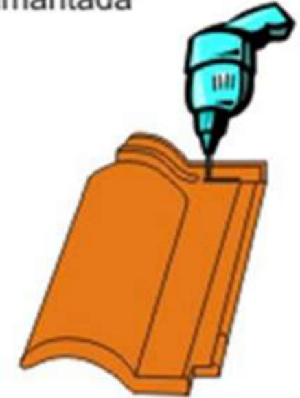
Furo na parte posterior da telha para fazer a fixação com parafuso ou arame
